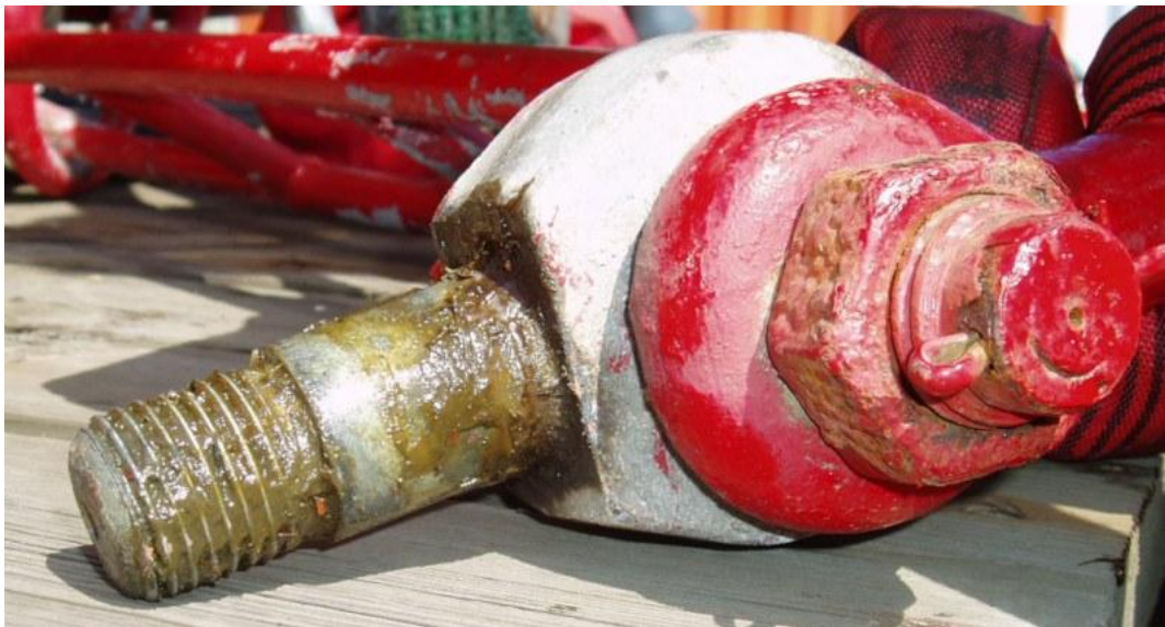
Vis de l'émerillon tribord après l'accident / Starboard swivel screw after the accident
